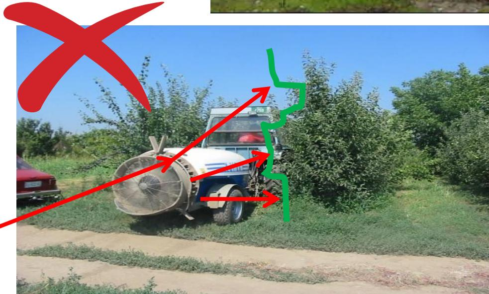
Orošivač sa "usmerivačkim tornjem" uz dobru kombinaciju i ugao rasprskivača omogućava pokrivenost bolju i za 20%.
